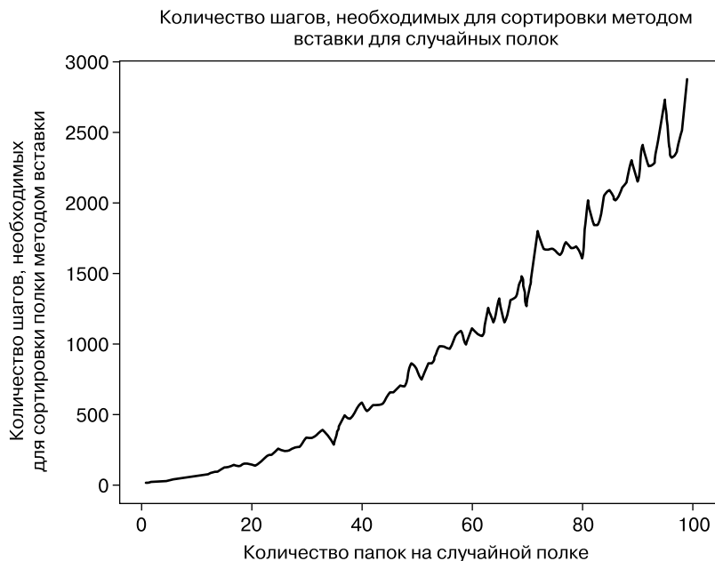
Рис. 4.1. Количество шагов при сортировке методом вставки
