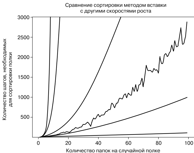
Рис. 4.3. Сравнение количества шагов сортировки методом вставки с другими скоростями роста
