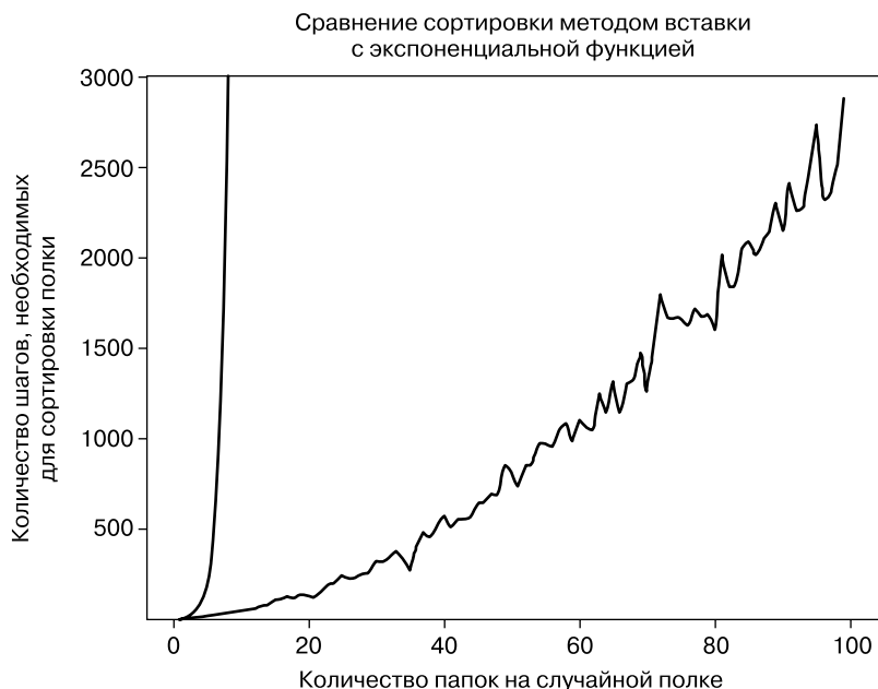
Рис. 4.2. Сравнение количества шагов при сортировке методом вставки с экспоненциальной функцией
